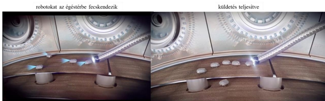
2. ábra. Rolls-Royce endoszkópszerű „kígyórobotja” lerakja a SWARM robotokat [8]
