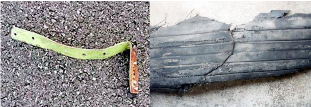
5. ábra. A katasztrófát okozó lemezdarab [12]
