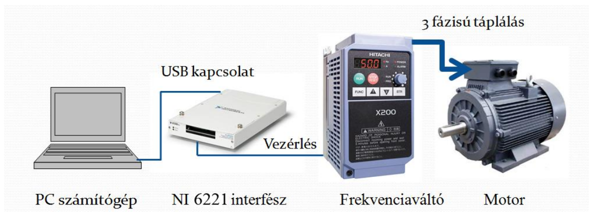
3. ábra. A frekvenciaváltó összekapcsolása a PC számítógéppel (forrás: saját ábra)
