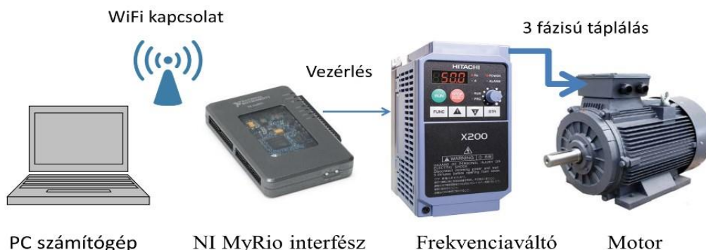
6. ábra. Távoli motorvezérlés MyRIO-val (forrás: saját ábra)
