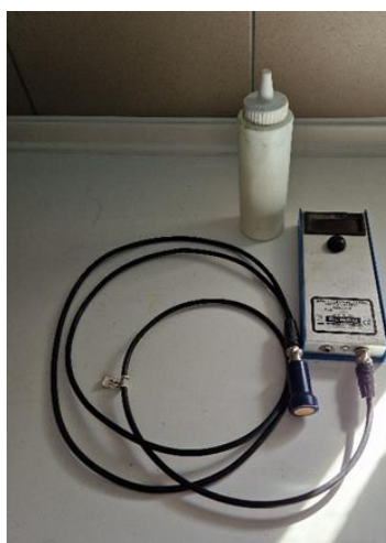
1. ábra: Ultrahangos hátszalonnavastagság-mérő műszer és az ultrahangszelé Forrás: Bozó D.
