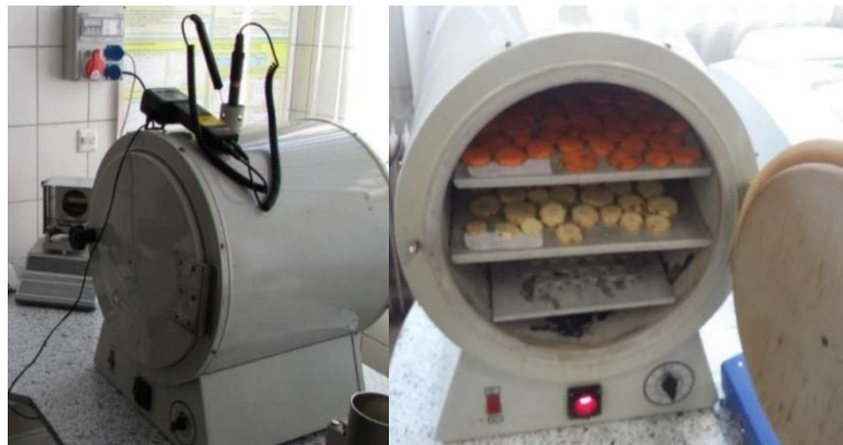
1. ábra: LP306 típusú hengersizító TESTO hőmérséklet- és páratartalom-mérő berendezéssel Forrás: saját felvétel
