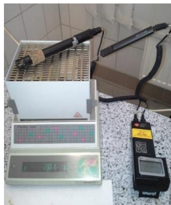
2. ábra: Az infravörös szárítást (Precisa HA) megvalósító berendezés a Testo készülékkel Forrás: saját felvétel
