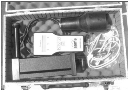
5. ábra. A kézi átfolyásmérő és használata (Forrás: saját felvétel)
