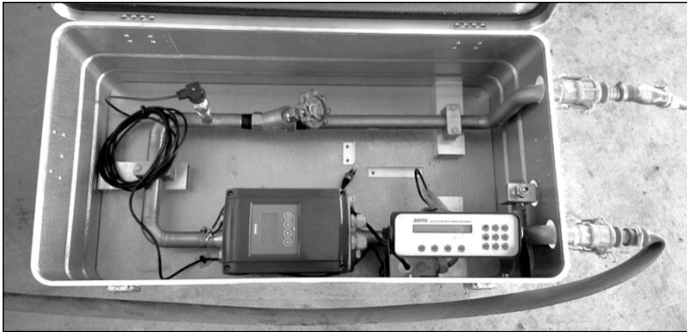
3. ábra. Mérőkoffer a szivattyú vizsgálatára (Forrás: saját fel- vétel)
