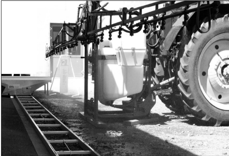
1. ábra. Sínpályán mozgó telemetrikus, ultrahangos vályúsor (Forrás: saját felvétel)
